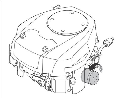
11. Lubrifiez légèrement le joint en caoutchouc sur le nouveau filtre à huile avec de l'huile neuve.
