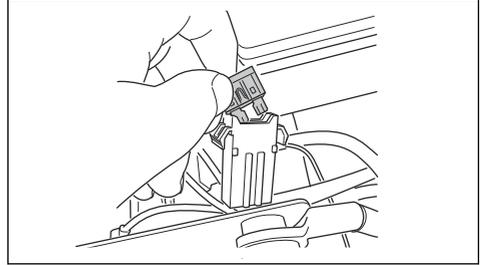
3. Remplacez le fusible grillé par un fusible neuf du même type, plat 15 A.
