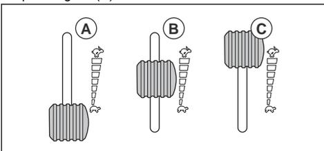
**Remarque:** L'engagement des lames lorsque le moteur est à plein régime entraîne des tensions sur les courroies d'entraînement. N'appliquez pas le plein régime tant que le carter de coupe n'est pas en position de tonte.
