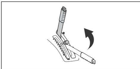
Pour abaisser l'unité de coupe en position de tonte, appuyez sur le bouton de verrouillage et déplacez le levier de levage vers l'avant. Si le moteur est en marche, les lames commencent à tourner automatiquement.
