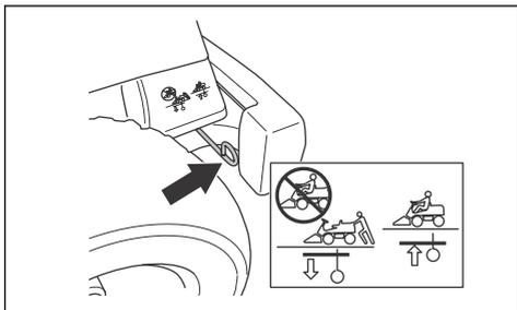
Le levier du système d'entraînement pour l'arbre avant de la R 216T AWD se trouve derrière la roue avant gauche.
